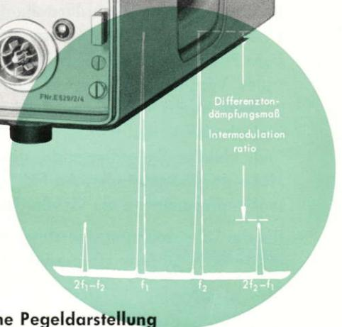
**Einblendbare quartzgesteuerte Frequenzmarken** mit 0,1 MHz oder 0,5 MHz Abstand und die Hervorhebung der Marke für die Empfangsmittenfrequenz gestatten die Festlegung eines Frequenzmaßstabes auf dem Bildschirm. Mit Hilfe des Markenspektrums kann auf einfache Weise die absolute Frequenzablage einer Spektrallinie und somit auch die Modulationsfrequenz bestimmt werden.
